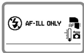
：スピードライトの発光を禁止し、AF補助光だけを照射します。
