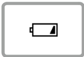
電池容量が不足すると、表示パネルが左の画面に変わり、すべての動作が停止します。新しい電池に交換または充電してください。
