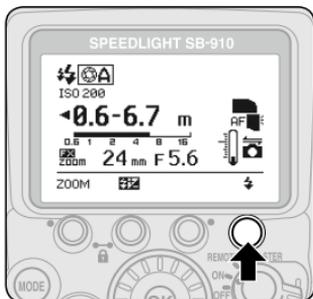
実際の撮影と同様にカメラとSB-910を設定し、テスト発光します。
