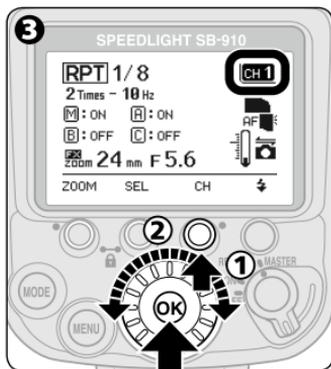
③ ファンクションボタン3を押してチャンネル表示を反転させ、セレクターダイヤルで選択し、[OK] ボタンを押す
