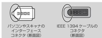
**メモ** 付属の IEEE 1394 ケーブルは 6 ピン - 6 ピンタイプです。ご使用のパソコンの IEEE 1394 インターフェースコネクタ (DV 端子) が 4 ピンの場合は、市販の 6 ピン - 4 ピンタイプの IEEE 1394 ケーブル、または 6 ピン - 4 ピン変換器を別途ご購入ください。
