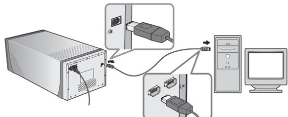
IEEE 1394 ケーブルのコネクタはスキャナやパソコンの IEEE 1394 インターフェースコネクタの形状に合わせて正しい向きで差し込んでください。逆向きのまま無理に差し込むとコネクタを破損するだけでなく、スキャナおよびパソコンの破損・故障の原因となります。
