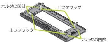
**5-2** プロネフィルムをホルダにセットします。フィルムのベース面 (光沢のある面) が上、乳剤面が下になるようにしてフィルムの端をホルダの突起部に突き当てます。
