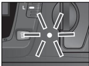
撮影すると、CFカードに画像の記録が行われている間、CFカードアクセスランプが点灯します。点灯が消えるまで、カメラの電源スイッチをOFFにしたり、CFカードやバッテリーを取り出したり、ACアダプタEH-5（別売）を取り外したりしないでください。
