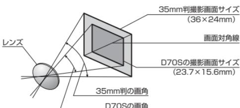
35mm判カメラの撮影画面サイズは、対角線の長さでD70Sの撮影画面サイズの約1.5倍です。したがって、D70Sに35mm判カメラ用レンズを装着した場合、その焦点距離はレンズに表記された数値に1.5を掛けた値に相当します。
