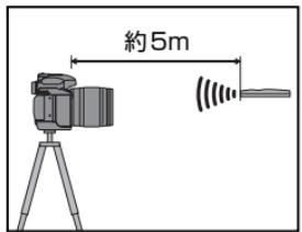
**4** リモコンML-L3の送信部をカメラのリモコン受光部に向け、送信ボタンを押します。
