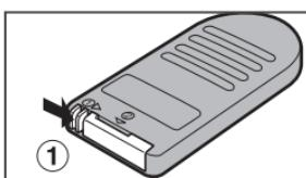
1 電池ホルダー着脱レバーを矢印の方向にスライドさせて、ロックを解除しながら(①)、リモコン本体から電池ホルダーを取り出します(②)。
