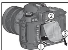
モニタカバーを装着する場合は、液晶モニタ部の上にある溝にモニタカバーの上部をはめ込み（①）、モニタカバーの透明な部分が液晶モニタと重なるように置き、カチッと音がするまで上から軽く押してください。（②）。
