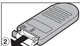
2 電池ホルダーからリモコン用の電池を取り出します。
