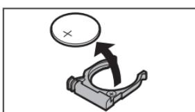
3 CR2025型3Vリチウム電池1個を+極側を上にして電池ホルダーに入れます。
