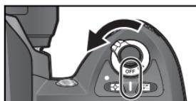
1 カメラの電源スイッチをOFFにします。
