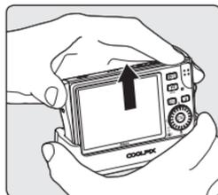
図のようにカメラとCOOL-STATIONを持って取り外してください。
