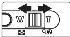
光学ズームを最も望遠側にして、さらに**T** (Q) 方向に倒し続けると、電子ズームが作動し、光学ズームの最大倍率(約3倍)の約4倍(合計約12倍)まで拡大できます。
