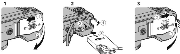
バッテリー/SDカードカバーを閉める前に、パワーコネクターのコードをバッテリー室の溝に奥まで入れてください。コードが溝からはみ出していると、カバーを閉めたときにカバーやコードを破損するおそれがあります。
