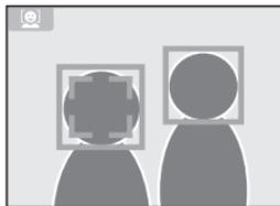
人物の顔が ☺ マークと同じ程度の大きさになると、カメラが顔を認識し、液晶モニターに四角い黄色の二重枠で示します。
